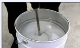
2 - O misturador deve estar completamente imerso, no material a ser misturado, antes de acionar a rotação. Mantenha imerso, enquanto estiver em movimento.
