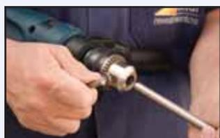
1 - Acople firmemente o misturador SolarMix a um equipamento tipo furadeira de rotação variável.
