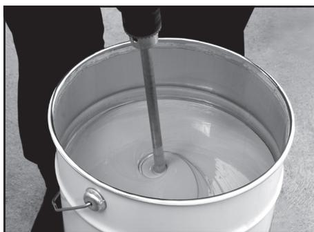
2 - O misturador deve estar completamente imerso, no material a ser misturado, antes de acionar a rotação. Mantenha imerso, enquanto estiver em movimento.
