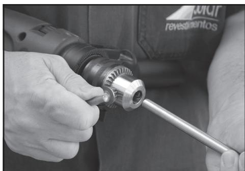
1 - Acople firmemente o misturador SolarMix a um equipamento tipo furadeira de rotação variável.
